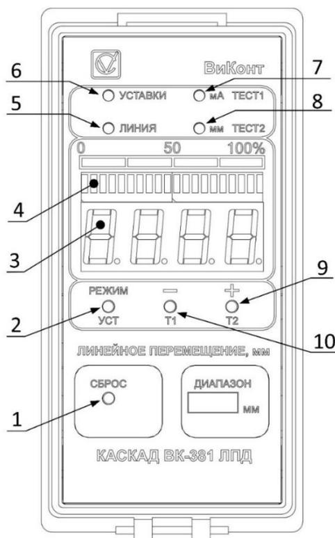
1. Кнопка «СБРОС» для переключения блока в основной режим.
