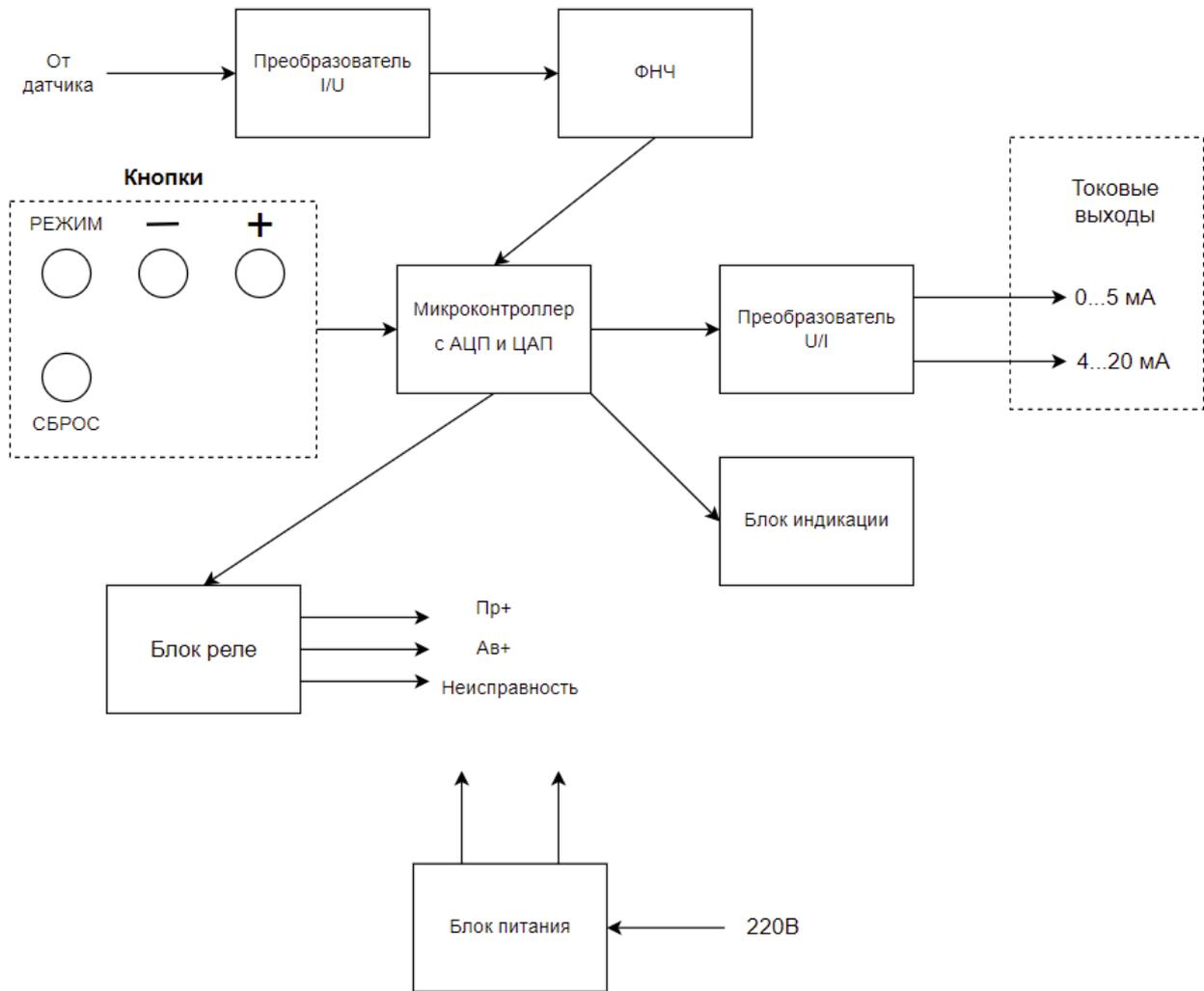
Рисунок 3 – Блок-схема блока вторичного ВК-381ЛПД
