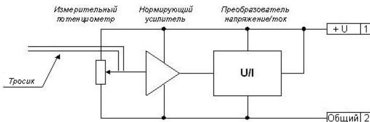
Рисунок 1 – Структурная схема преобразователя ВК-318.20
