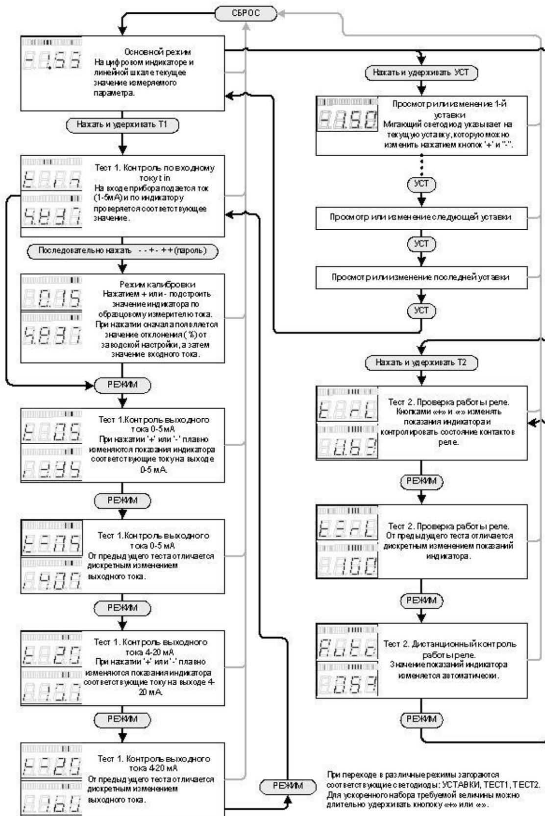
Рисунок 7 – Блок-схема
